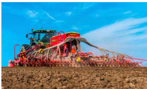
Spirit 600-900S permite închiderea a jumătate din utilaj din scaunul operatorului.
