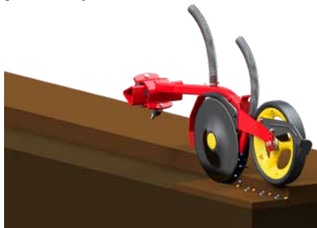
Versiunea InLine plasează fertilizatorul într-o intrare separată împreună cu semințele în brazdă de semințe.
