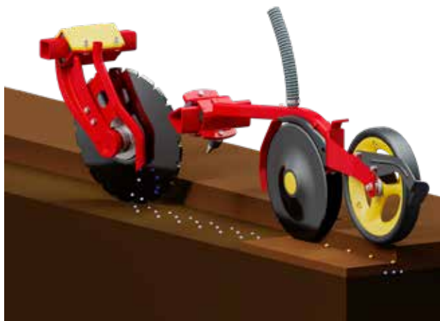
Versiunea FIX plasează fertilizatorul în benzi de 5 cm la fiecare 125 mm distanță, în fața fiecărui rând de semănat.
