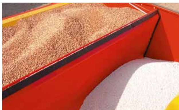
Rapid 300-400C/S are un buncăr de capacitate mare. Pe modelele combi, capacitatea relativă de semințe/fertilizator poate fi ușor modificată.
