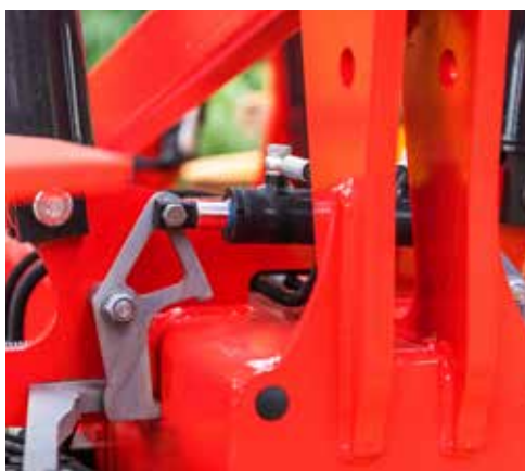
Controlul Carrier XT, inclusiv al blocatorului hidraulic al secțiunii laterale, este ușor de realizat din cabină.
