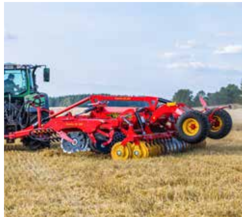
În câmp mașinile pot fi întoarse fie pe tăvălug fie pe roți la capetele rândurilor.
