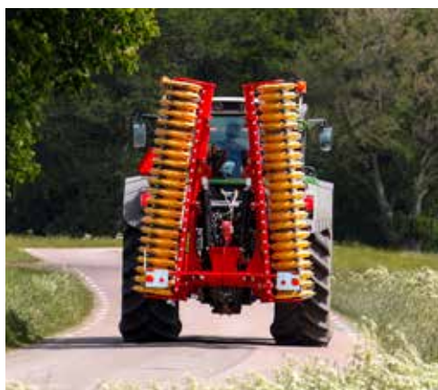
Lățimea de transport a utilajului Carrier XT purtat este de doar 2,4 m.
