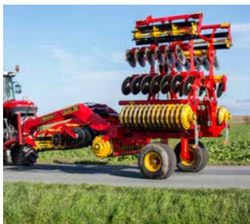
Modul în care se pliază Carrier 420-820 asigură centrul de greutate jos și manevrabilitate bună în transport, precum și conturare excelentă în câmp.
