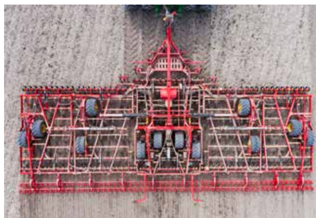
Boghiul suport lat OffSet susține NZ Extreme și menține adâncimea de lucru.
