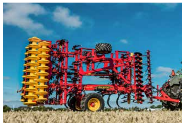
TopDown 300-700 se pliază la 3m lățime de transport.
