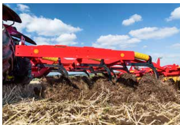
Dinții Cultus sunt capabili să lucreze cu performanțe înalte până la 25cm adâncime.
