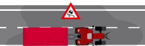
Sistemul avansat de franare a remorcii recunoaste in mod activ situatia curenta de conducere si stabilizeaza ansamblul format din tractor si remorca folosind franele remorcii.
