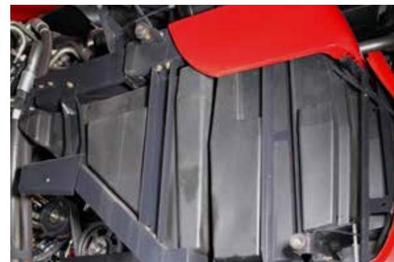
Capacitate rezervor de carburant de 1,125 litri (7250, 8250) sau 1,200 litri (9250) pentru zile lungi de lucru. Dacă este echipat cu tocatorul Xtra-Chopping, modelul 9250 are o capacitate de 1020 litri
