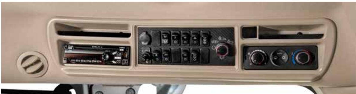
Pentru control total, comenziile utilizate cel mai frecvent sunt amplasate la indemana si dispuse ergonomic, ceea ce permite gestionarea usoara a tuturor functiilor hederului si operarea melcului de descarcare. In plus, a fost inclus un buton de oprire urgența pentru elevator si heder.
