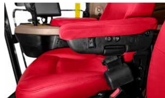
Scaun cu suspensie pneumatica sau scaun din piele semiactiva, ventilat, incalzit, cu comenzi, pentru un nivel de confort de lux in autovehicul
