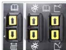
Reglare usoara a vitezei tocatorului sau schimbare de pe imprastiere in braza cu un buton exterior, situat pe partea laterala a combinei
