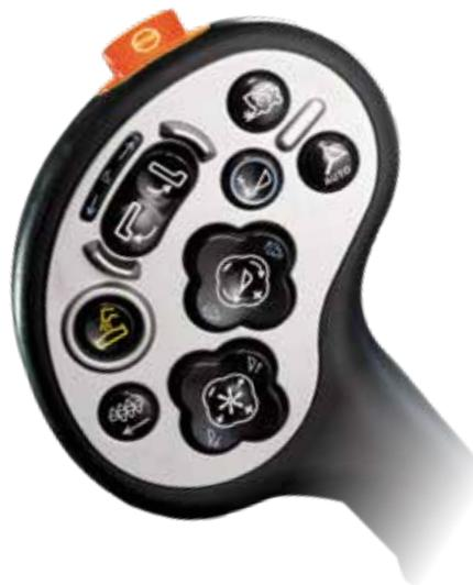
Functia de control al vitezei de avans poate fi utilizata prin simpla apasare a unui buton de pe manerul multifunctional
