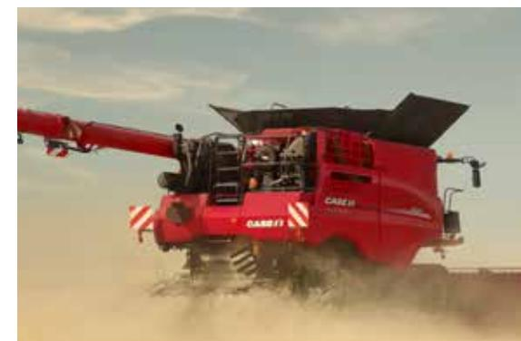
Tocatorul Xtra-Chopping este montat in partea din spate a combinei, pentru tocare fina in conditii agresive sau pentru operatiuni in braza. 96 de cutite si 12 lame de ventilator toaca si ambaleaza reziduurile intr-o cortina de aer pe toata latimea de lucru.
