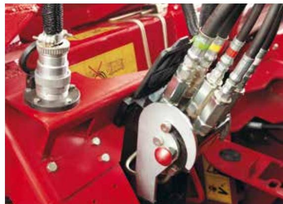
Montati hederul in doar cateva minute cu singurul blocaj care conecteaza toate serviciile hidraulice si electrice
